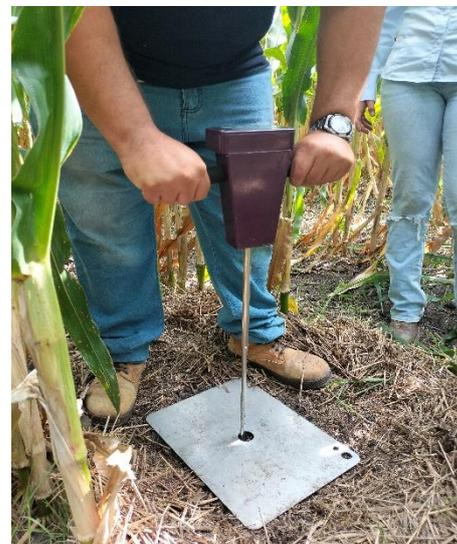
**Figura 26 y 27. Medidor de compactación del suelo digital**
